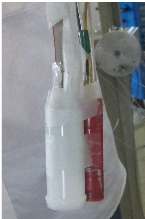
Slika 5.2: Pretočna ionizacijska celica (rdeče) in RadFET v polietilenski kapsuli.
